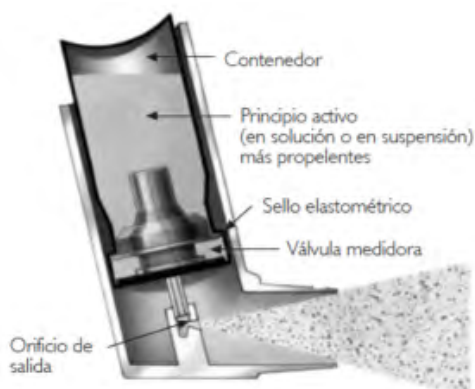
Figura 4. Esquema dels components de l'inhalador MDI (Bustamante i Gaete, 2007).
