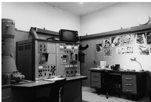
El primer microscopi electrònic de rastreig d'Espanya, un Cambridge Stereoscan S4, ubicat al primitiu Servei de Microscòpia Electrònica de la Universitat de Barcelona. Arxiu Servei de Microscòpia Electrònica.
